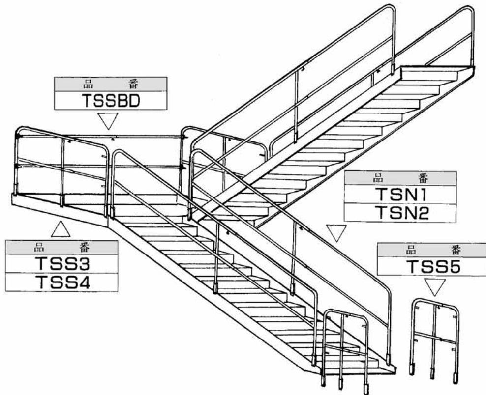
**留意点** : 取付金具 TSKL (平鋼用) はすべて取り付けられた状態にて出庫しています。ささら桁溝型の場合は、TSKLに TSKS を取り付け使用してください。
