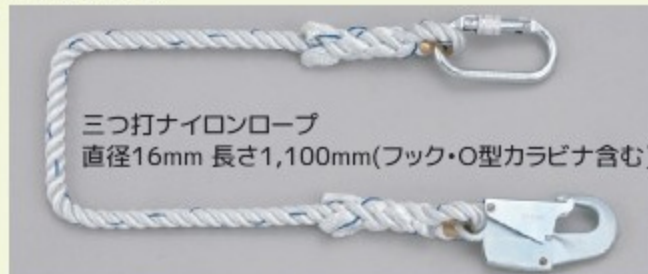
O型カラビナ OYK型(安全環付きスチール製 有効径: 17mm)
