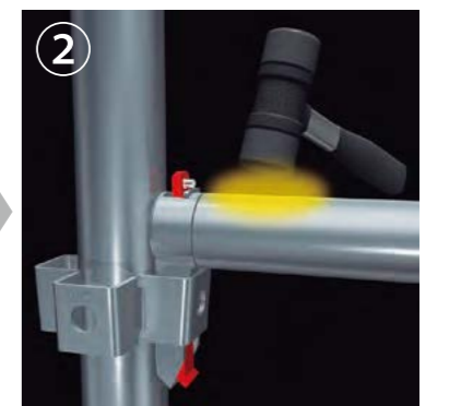
②打込みポイントを1回叩く ※抜け止めロックは叩かないでください。
